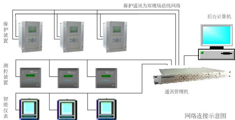
使用屏蔽双绞线将保护装置的通讯接口连接至通讯管理机，再由通讯管理机送至后台计算机，构成现场总线通讯模式。
